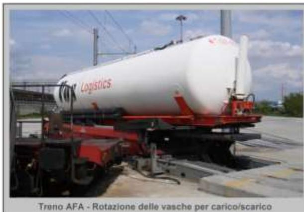
Treno AFA - Rotazione delle vasche per carico/scarico
